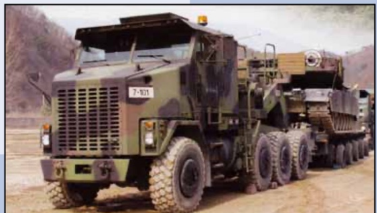
Een M1070 trekker met een M1000 oplegger (►). De 27 transport combinaties van het 7 e KSC bataljon waren voortdurend bezig met M1A1 gevechtstanks naar het front te brengen. Een dergelijke combinatie weegt ca. 100 ton
