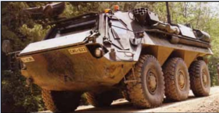
M93A1 Fox voertuigen van de 4 e Chemische Compagnie voeren speciale NBC-verkenningen uit. Dit ruim 18 ton zware mobiele laboratorium kan lucht-, water- en grondmonsters onderzoeken en vaststellen of er sprake is van gevaarlijke chemische besmetting
